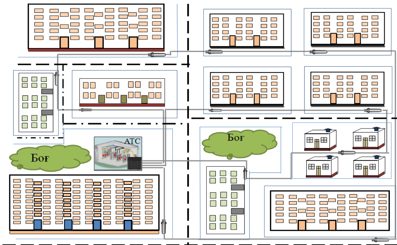
3.4-rasm. Orzu mahallasida PON texnologiyasi bo'yicha tarmoq yaratish sxemasi
