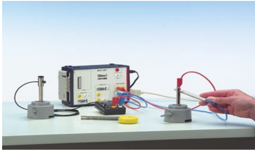
Рис. 1. Внешний вид экспериментальной установки. Выход усилителя микрофона с помощью разъема соединяется со входом блока Cobra 3 «Таймер 1».
