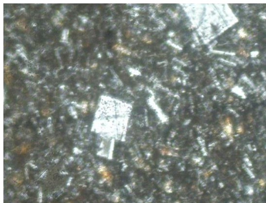
72-rasm. Plagiogranitdagi kulrang kvars, 73-rasm. Andezitdagi plagioklazn oq plagioklaz va qora rogovaya obmanka i idiomorf kristali. Nikollar +
