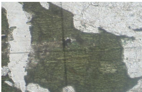
11-rasm. Ayrim minerallarga darzlik xos emas- kvars ( uzun oq). Nikollar II
