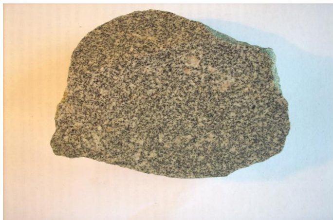
-rasm. Mayda donali (0.5-1 mm) struktura
