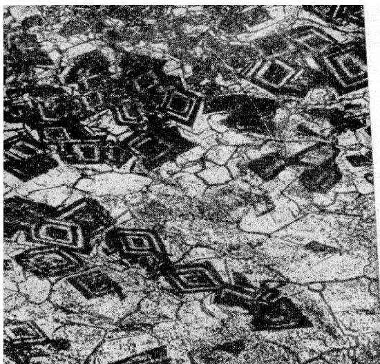
5-rasm. Shaklsiz kalsit donalarining orasida joylashgan dolomit (idiomorf) romboedrlarining zonal tuzilishi. Kae bo'yicha. Nikollar II
