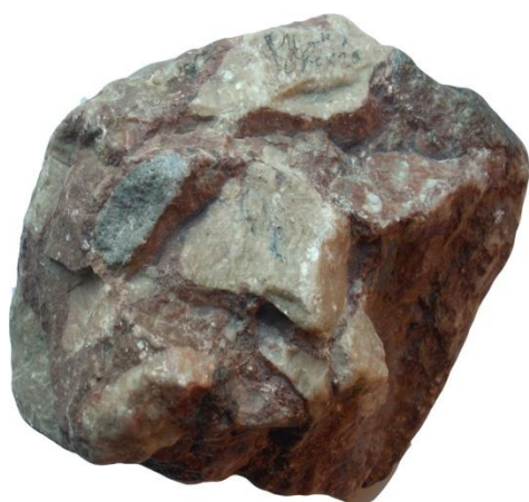
-rasm.Psefitli struktura (2mm dan katta). Brekchiya
