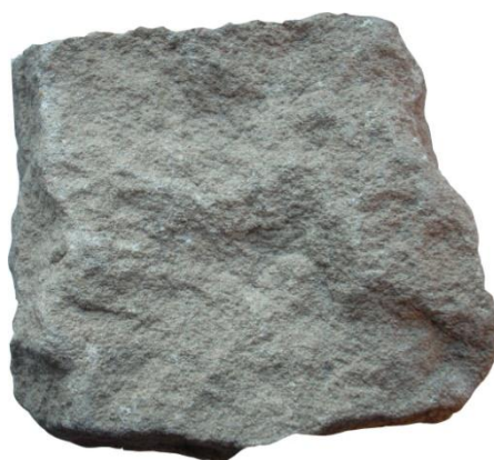
-rasm.Psammitli struktura qumtosh
