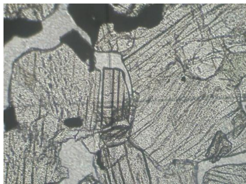
12-rasm. Kalsitni o'ta mukammal va mukammal darzliklari. Nikollar II
