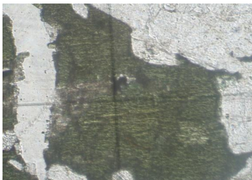
62-rasm. Kvars (chap tomonda) rangsiz, darzsiz, S, relyefsiz, bir nikolda qo'shalog'i yo'q.
