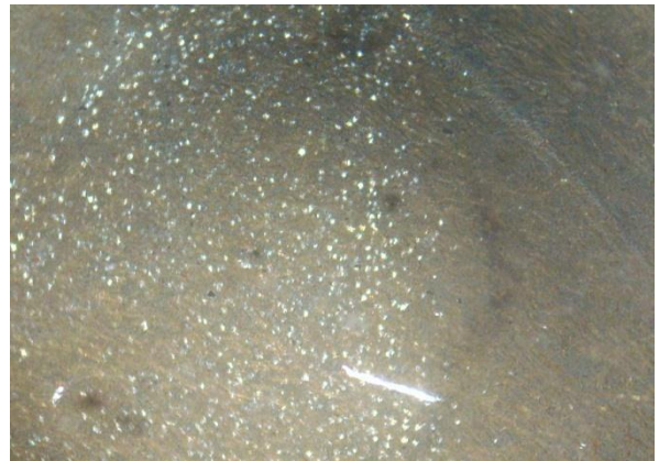
-rasm. Shishasimon stuktura. Nik. +
