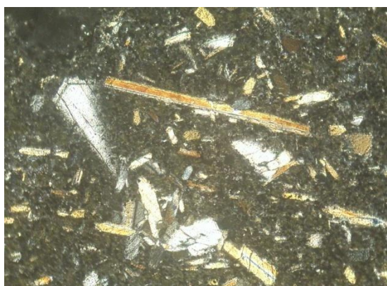
-rasm. Foto. Porfir strukturali bazalt. Nikollar+.
