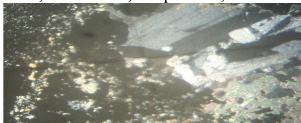
404-rasm. Geteroblastli struktura. granat (qora)- volostonitli (kulrang) skarn. Nikollar +
