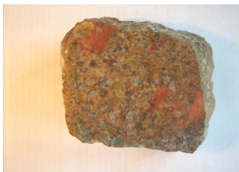
146-rasm. Teng donali bo'lmagan struktura. 1:1 dan to 1:10
