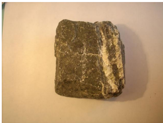
Serpentinit antigorit -xrizotil-asbest tarkibli
