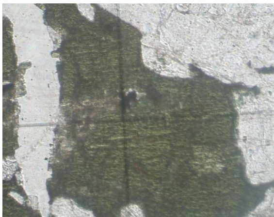
1-rasm. Mineral donalari ksenomorf qirralar shaklsiz. Kristallga xos bo'lgan rivojlanmagan. Nikollar II
