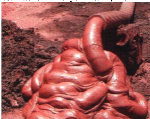
Рис.7.9. Нижний слив пастового сгустителя
