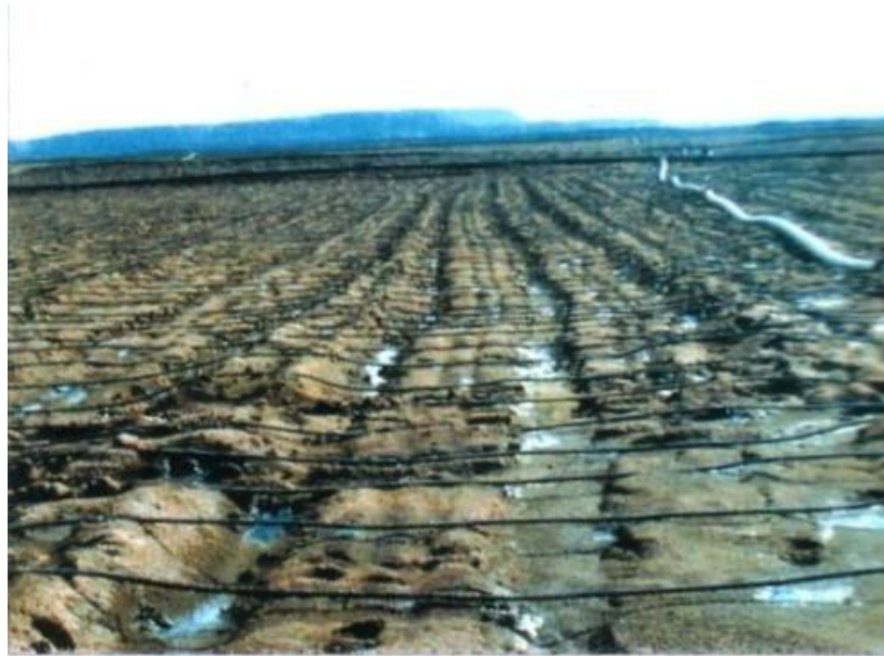
Рис.8.20. Система орошения на поверхности штабеля с помощью эмиттеров
