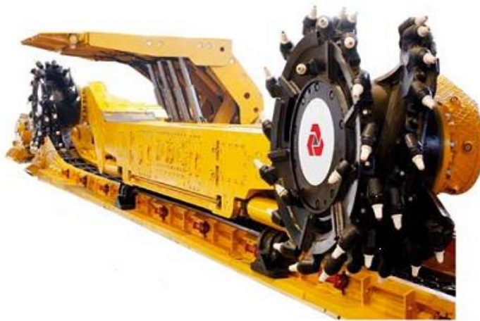
15.1-rasm. Yer osti konlarida ishlatiluvchi qazib olish kombayni
