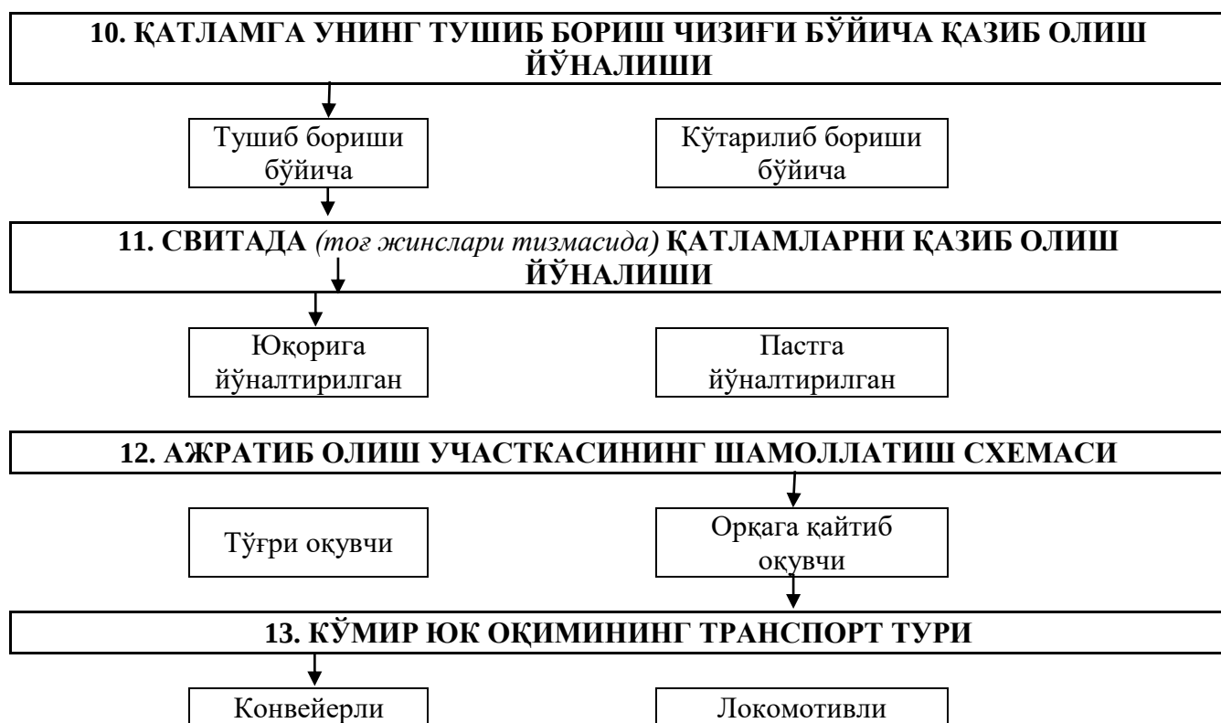
12.1–рasm. Шахта технологик схемасини унинг сатҳлари элементлари бўйича конструкциялаштиришнинг блок-схемаси мисоли (чизиқ билан лойиҳанинг варианты кўрсатилган)
