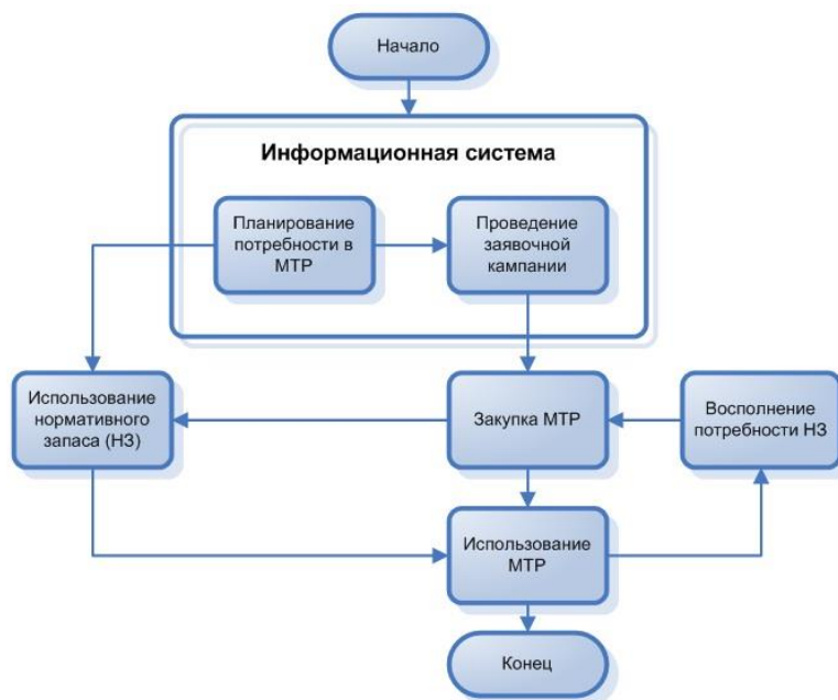
Рис. 8 Процесс материально-технического обеспечения предприятия с использованием информационной системы управления закупочной деятельностью
