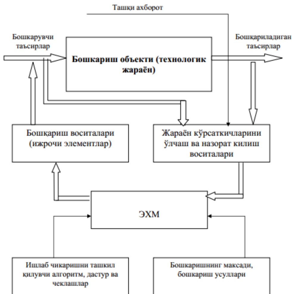
2 - расм. Технологик жараёнлари автоматлаштирилган бошқариш тизимининг асосий таркибий элементи ва улардаги ўзаро боғланишлар
