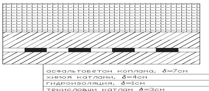
1-rasm. .O'tish qismi konstruksiyasi
