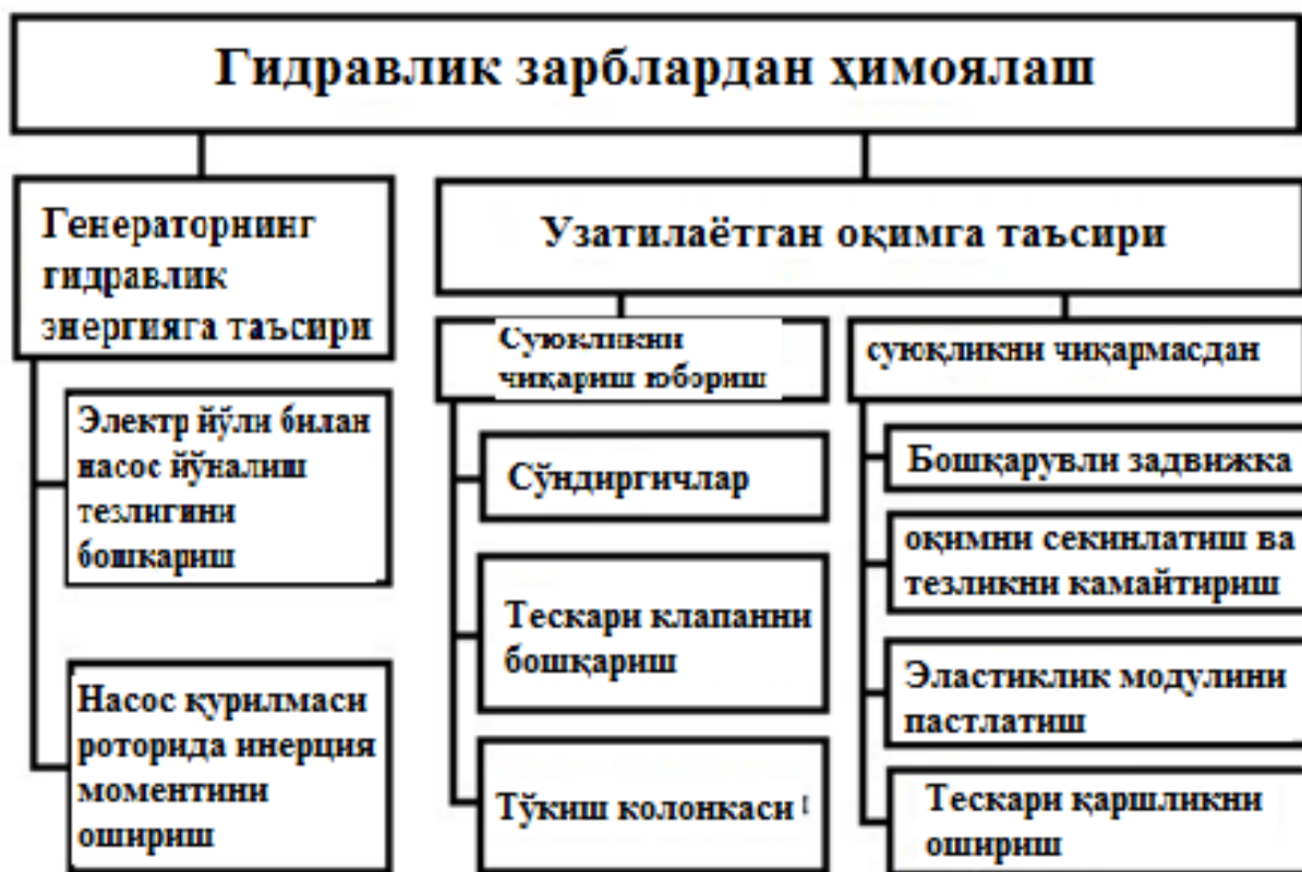
13. rasm – Gidravlik zarbalardan himoyalashning asosiy usullari.
