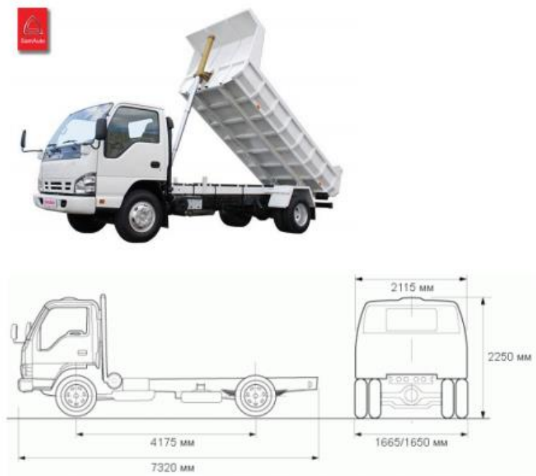
1.5-rasm. ISUZU NQR71 avtomobilini umumiy ko'rinishi. Qisqacha texnik harakteritikasi
