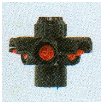
Multifim. Bosimni kompensatsiyalashtiruvchi bir necha chiqish yoʻli boʻlgan tomchilatuvchi moslama. Har bir chiqadigan tomonga sarflana-digan suv: 2, 3, 4 yoki 8 l/s
