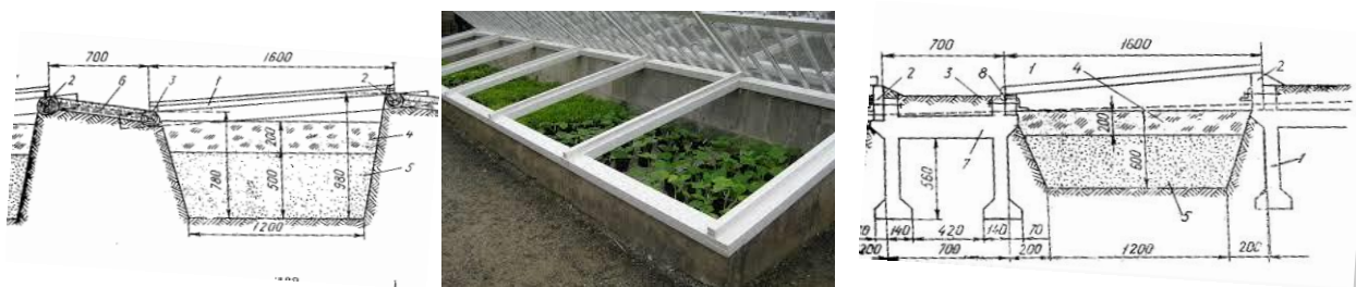
8-rasm. Biologik usulda isitiladigan yerga xandaq kavlab o'rnatilgan rus parnigining ko'ndalang kesimi:
