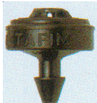
C.N.L. YUqori bosimni kompensatsiyalashtiruvchi zich yopiladigan tomchilatuvchi moslama. Suv sarfi: 3, 6, 12 l/s. Oxirgi bosimi: 4 m.
