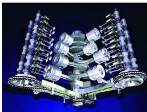
10-rasm. To‘rt taktli sakkiz silindrli V – simon dvigatel krivoship-shatunli mexanizmning sxemasi.
