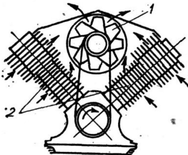
20- rasm. Xavo bilan sovitish tizimi.
