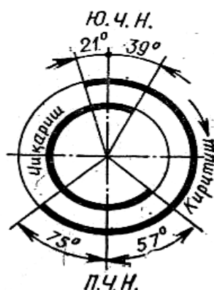
17-rasm. Avtomobil dvigateli gaz taqsimlash fazalarining doiraviy diagrammasi.
