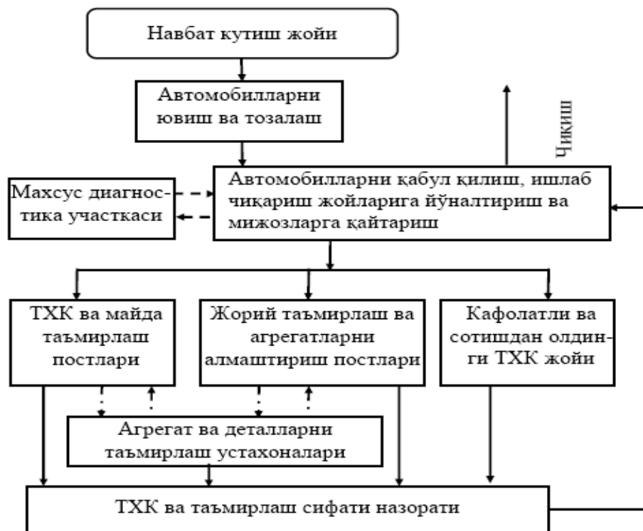
3.1-rasm. ASKlarida avtoservisni tashkil qilishning texnologik jarayoni.
