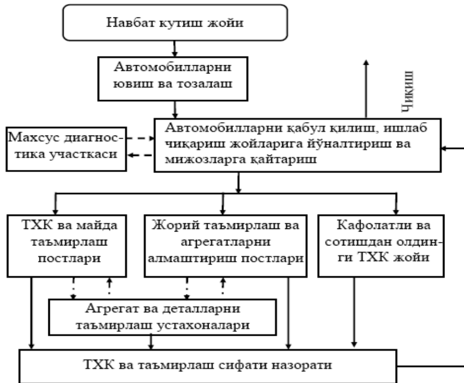
3.1-rasm. ASKlarida avtoservisni tashkil qilishning texnologik jarayoni.
