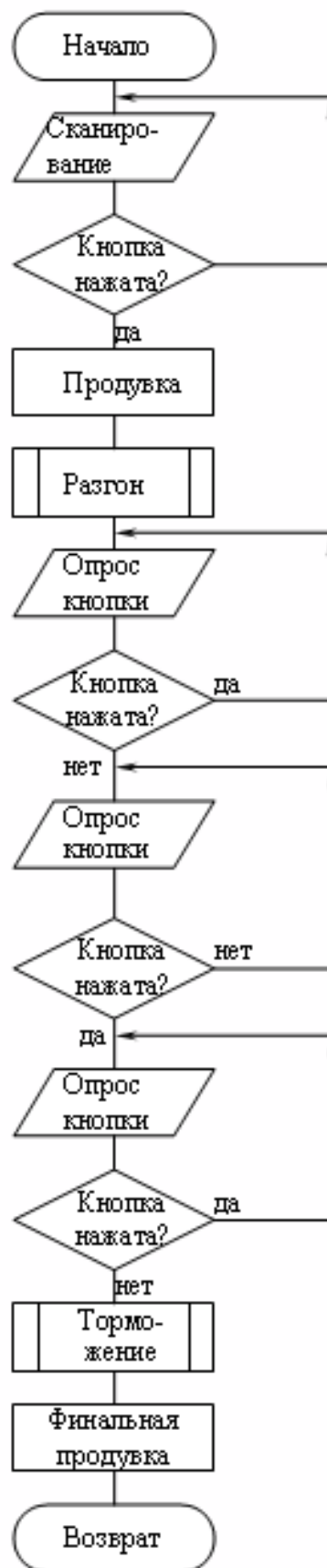
15–расм. Бошқариш тизими ишининг алгоритми В) Узун чокли пайванд дастури
