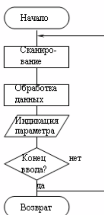
14–расм. Бошқариш тизими ишининг алгоритми А) Асосий дастур; Б) Қийматларни киритиш дастури.
