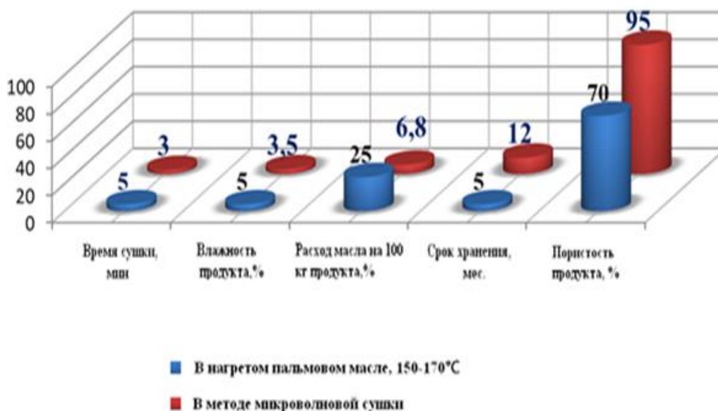
Рис.6. Сравнение результатов использования метода сушки в ЭМ поле СВЧ диапазона при производстве макаронных изделий быстрого приготовления.
