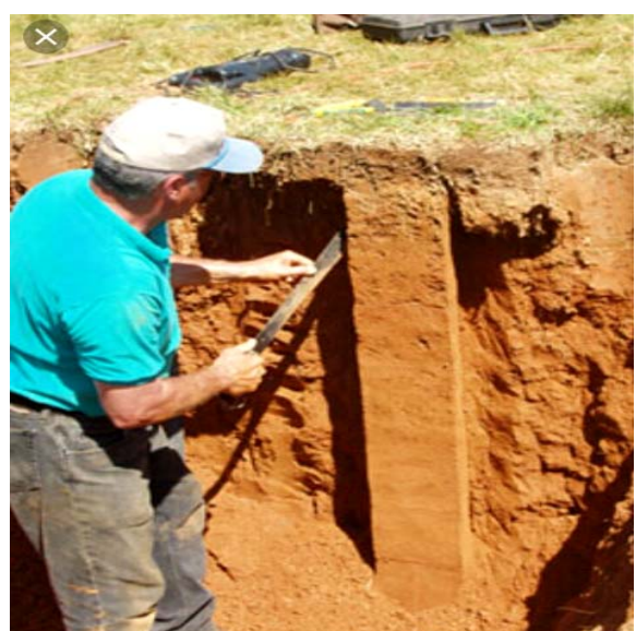
1.3-rasm. Monolit olish tartibi va monolit namunalari.
