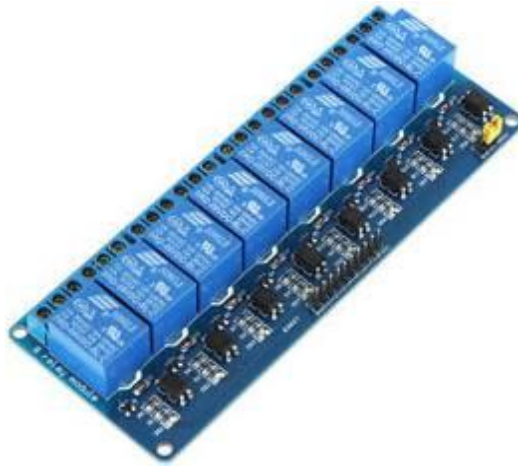
Рисунок 5.3 - Relay Shield с восьмью реле.
