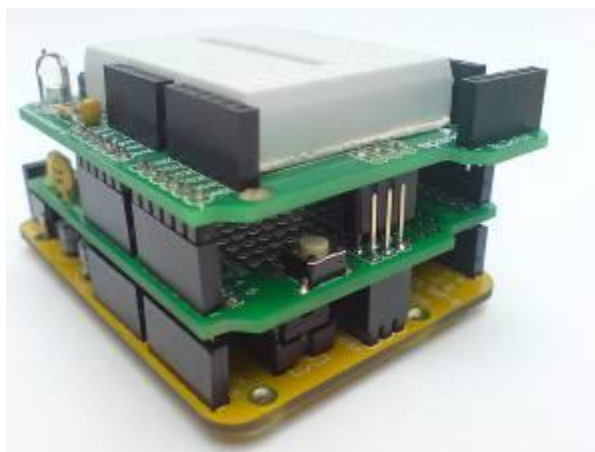
Рисунок 1.1 - Стандартный конструктив Ардуино с платами расширения.
