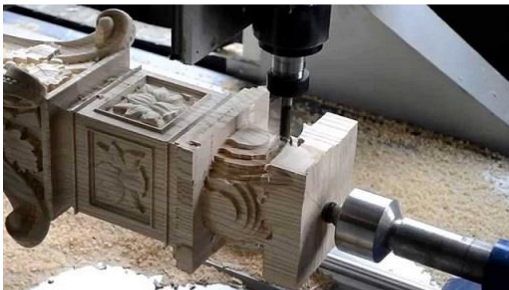
2.9-rasm. Raqamli dasturli boshqariladigan stanoklar (a – tokarli; b – frezer-gravyuralash stanogi)
