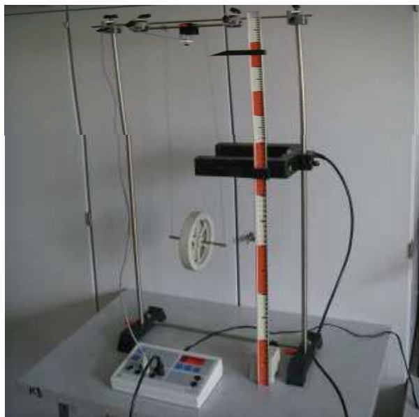
1-rasm: Maksvel diskleri yordamida energiya saqlanishi qonunini tekshirish uchun mo'ljallangan tajriba qurilmasi.
