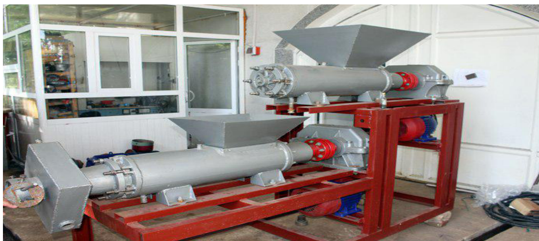
187-rasm. Sovun ishlab chiqarish uskunasi – ekstruder
