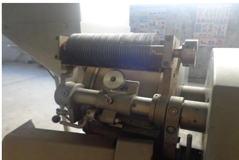
3.4.2.-rasm. Mevalarni kichik bo'lakchalarga kesish FAMILS-2 mashinasi.
