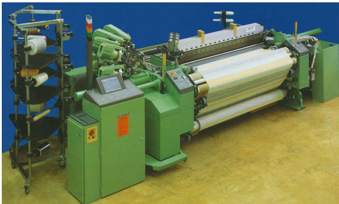
1.3.8-rasm - PS rusumli to'quv mashinasining umumiy ko'rinishi
