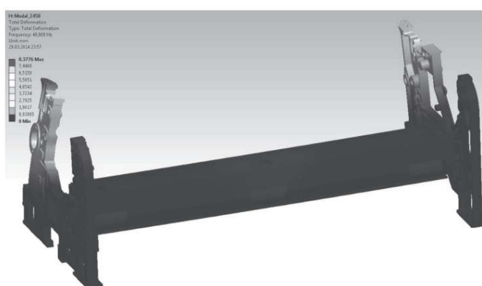
4.2.5.-rasm Solidworks dasturida birinchi va ikkinchi hususiy tebranishlar chastotasi hisoblangan sxemasi. a– birinchi chastota – 32,005 gerz; b– ikkinchi chastota – 40,069 gerz
