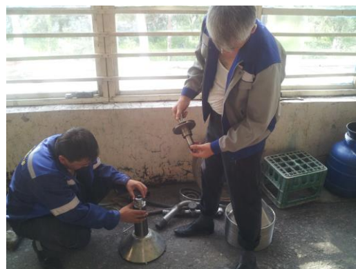
12-rasm. Seperatorni taqsimlash kamerasini o'lchamlarini taxlil qilinmoqda
