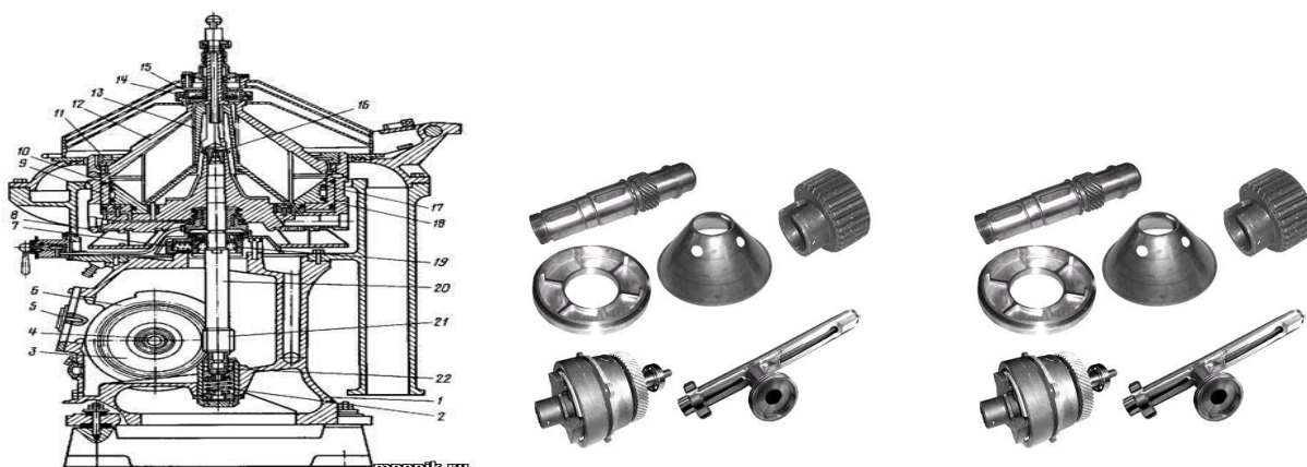
12-rasm. G9-KOV rusumli seperator ishchi mexanizm konstruksiyasilari
