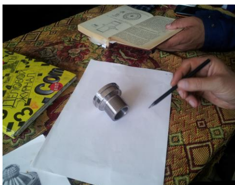
11-rasm. Rotor konstruksiyaiga asosan ishchi vtulkani tayolanish jarayoni
