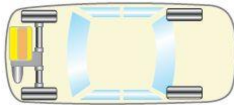
1.12-rasm. Oldingi gʻildiraklar yetakchi boʻlgan avtomobil
