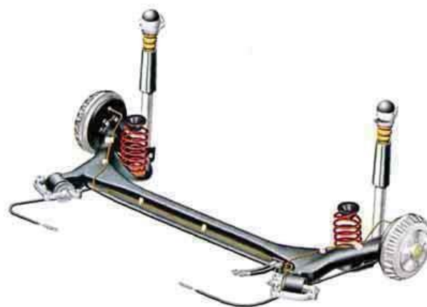
9.3-rasm. Oldi ko'prigi yetakchi yengil avtomobilning orqa tayanch ko'prigi
