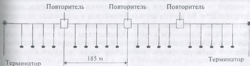
Рис. 6.7. Повторитель позволяет увеличить длину сети Ethernet.
