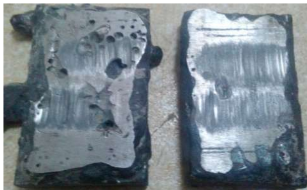
2-Rasm. Namunalarning yeyilishga sinovdan keyingi xolati
