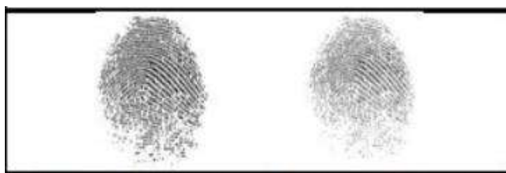
Рис 2 - Изображение слева взято из локально адаптивного алгоритма бинаризации, а изображение справа показывает выбранные гребни
