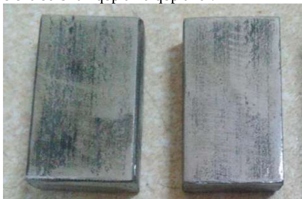
1-Rasm. Yeyilishga sinash uchun tayyorlab olingan namunalar
