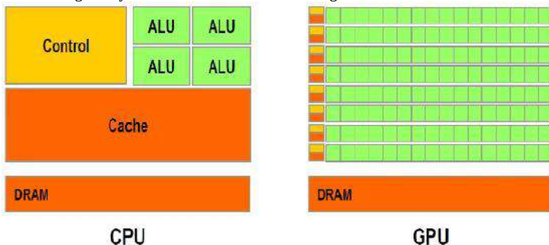
3-rasm. CPU va GPUning asosiy arxitekturasi.
