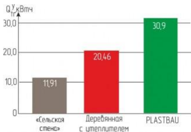
Рисунок 3. Теплотери в здании через 1 м² стены за отопительный период, кВтч
