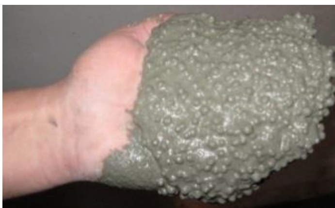
1- Рисунок. Однородность структуры полистиролбетона.
