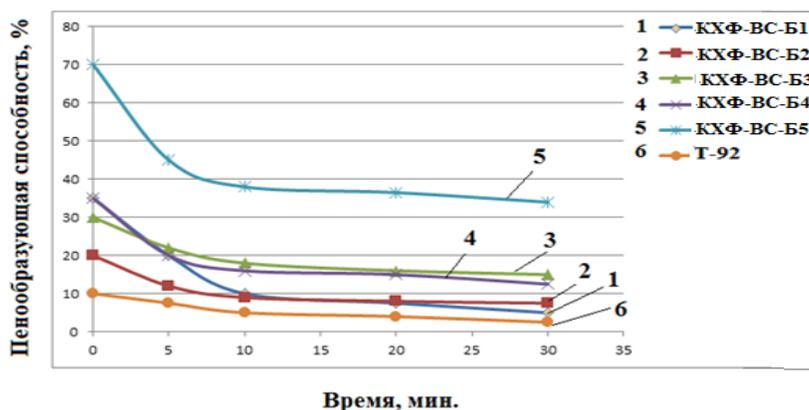
**Рис. 1. Пенообразующая способность и устойчивость пены водно-спиртовых растворов разрабатываемых флотореагентов-вспенивателей**
