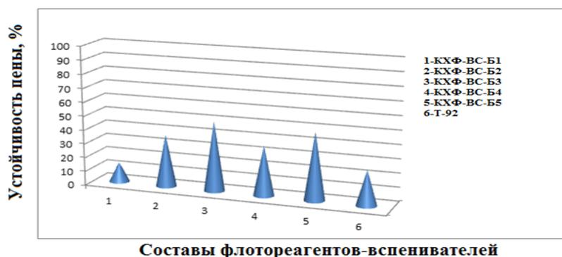
**Рис. 2. Устойчивость пены растворов флотореагентов-вспенивателей на водно-спиртовой основе**
