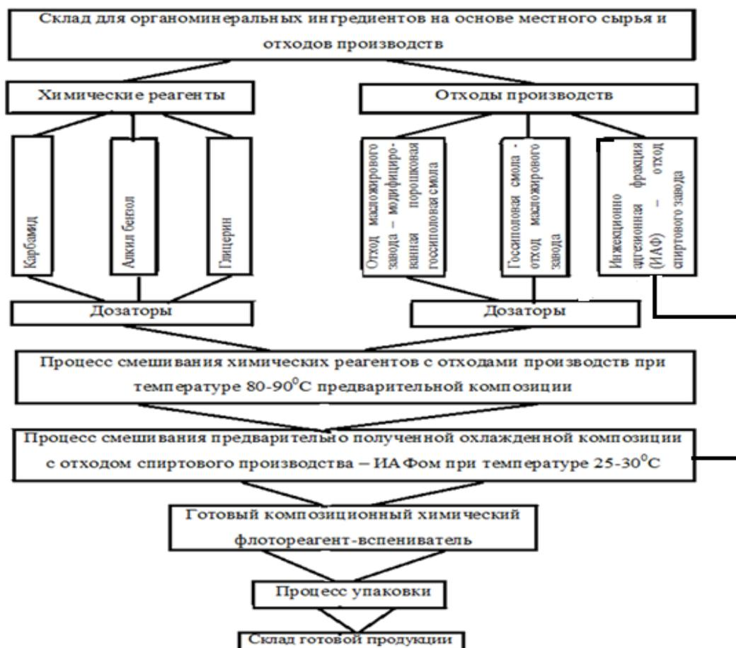
**6-Расм. Маҳаллий хом ашё ва саноат чиқиндилари асосида композицион кимёвий флотореагент-кўпиклантирувчи модда олишнинг технологик жараён схемаси**
