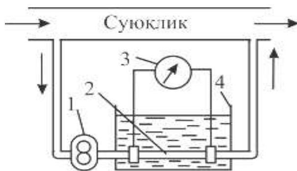
10- расм. Автоматик капилляр вискозиметрнинг принципиал схемаси.
