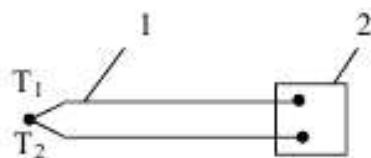
2-Расм. Термоэлектрик термомпара 1- термомпара, 2- улчов асбоби.
