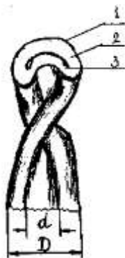
21-rasm. Tolaning qatlamlari va pishganligini aniqlovchi o'lchamlari
