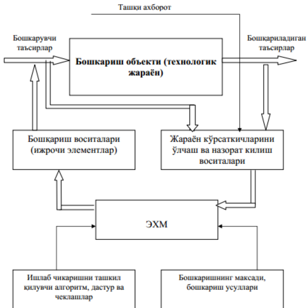
2 - расм. Технологик жараёнлари автоматлаштирилган бошқариш тизимининг асосий таркибий элеменлари ва улардаги ўзаро боғланишлар
