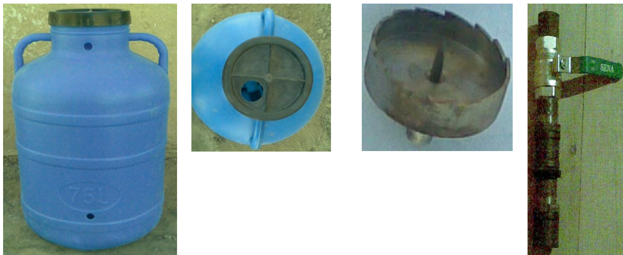
Расм 12. Сув сатҳини барқарор ушловчи идиш ва ундаги сатҳни назорат қилувчи тешиклар ( a ), сув узатувчи идишни сатҳни барқарор тутув-чи идиш билан улаш учун махсус пармада ( б ) очилган тешик ( б ) ҳамда уларни бири-бирига муфталар орқали уловчи махсус кран ( г ).
