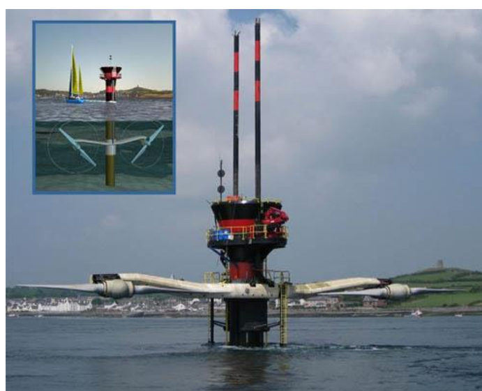
Сув sathning ko‘tarilib-tushish prinsipi asosida ishlaydiganeng katta turbina
