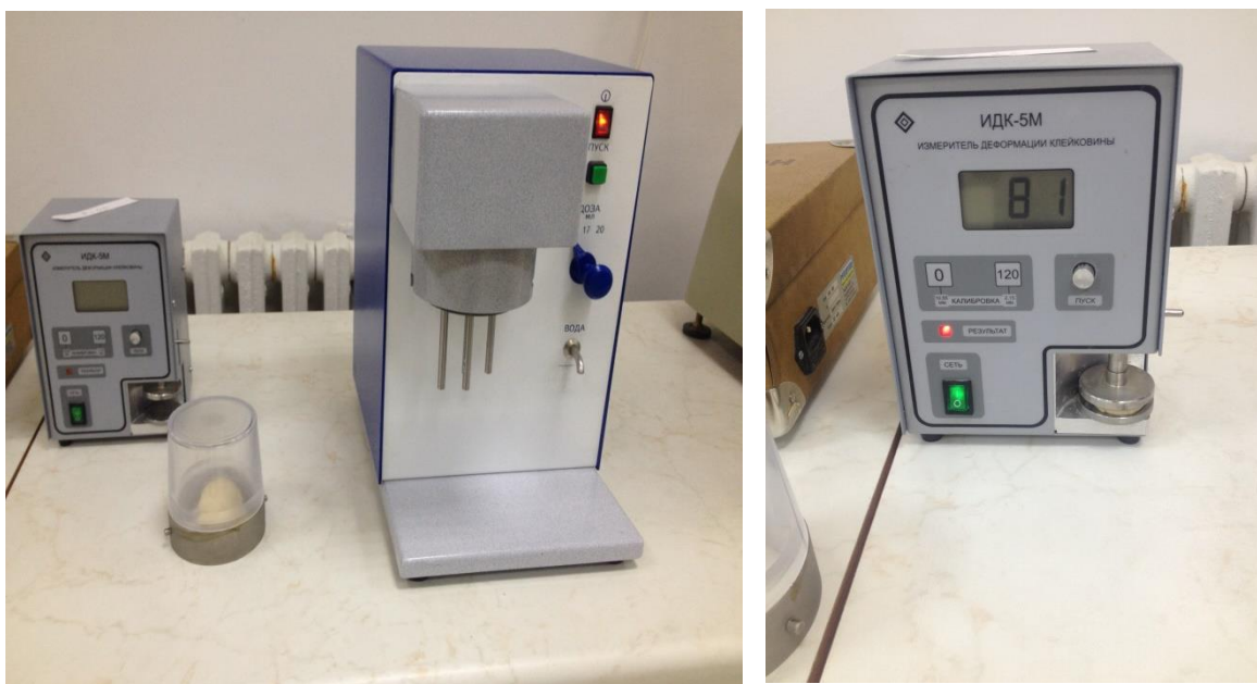
2 – rasm. Kleykovina sifatini aniqlashga mo'ljallangan IDK-5M asbobi.
