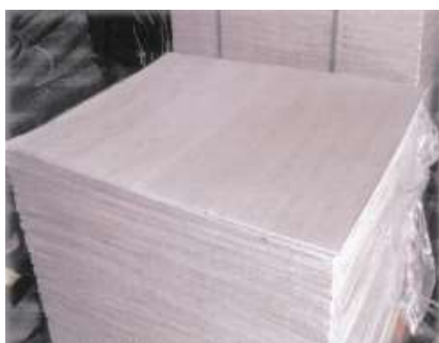
Ishlash harorati 500^\circ\text{S} gacha bo'lgan quvurlarni issiqlik izolyatsiyasi va yog'och va yonuvchan narsalarni
