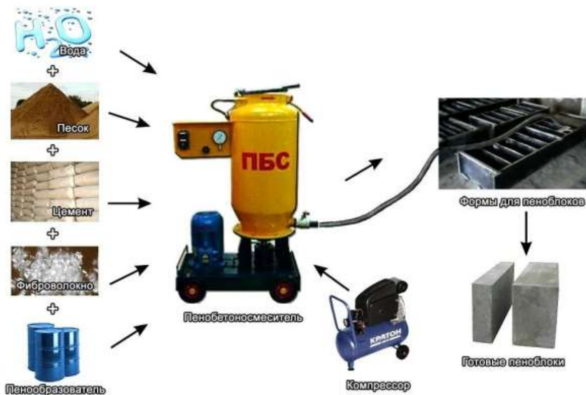
7.2-rasm. Ko'pik beton ishlab chiqarish texnologiyasi.
