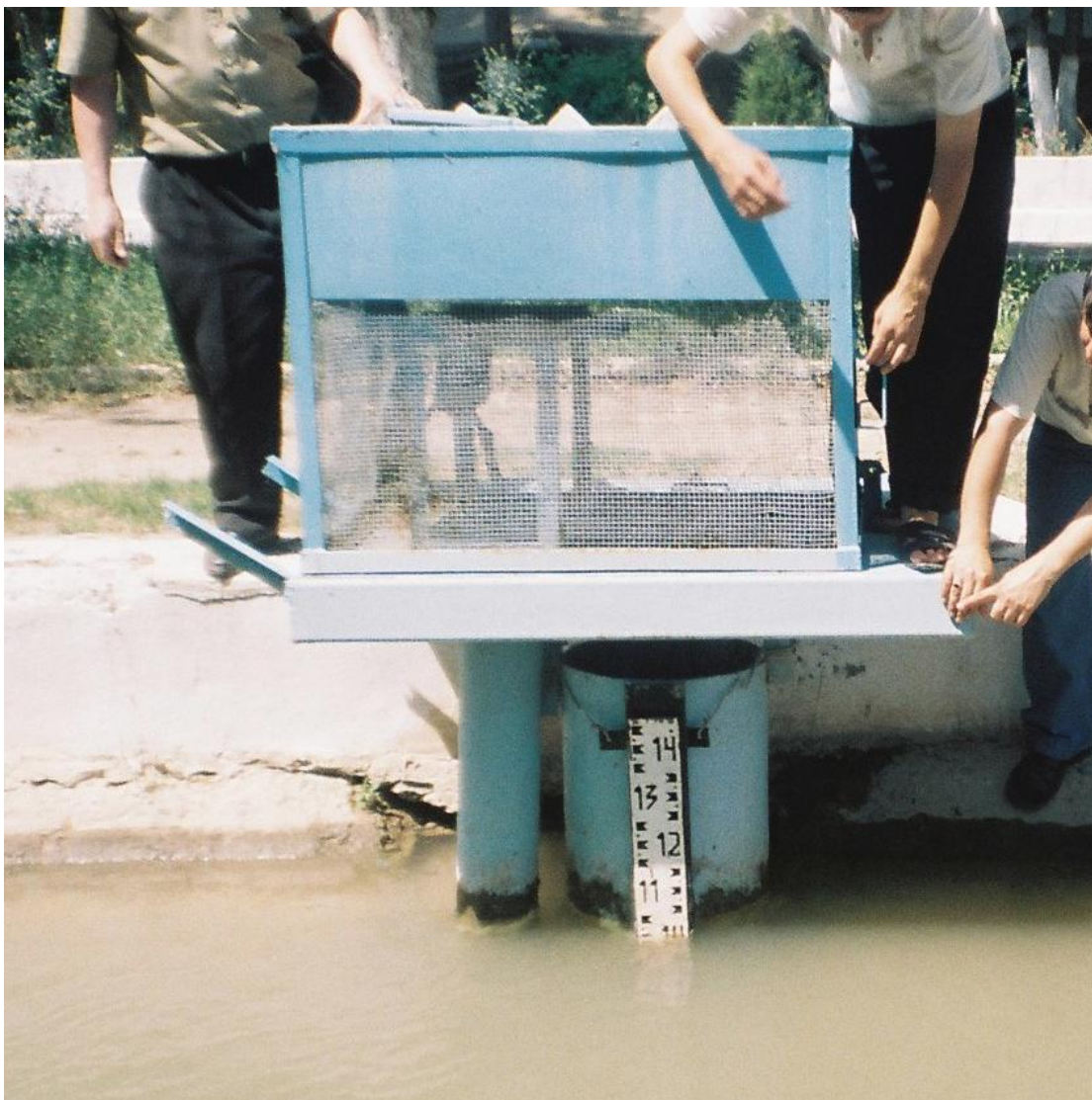
2.1.3-расм. РК-7 каналининг ўзгармас ўзан шаклидаги сув ўлчаш пости.
