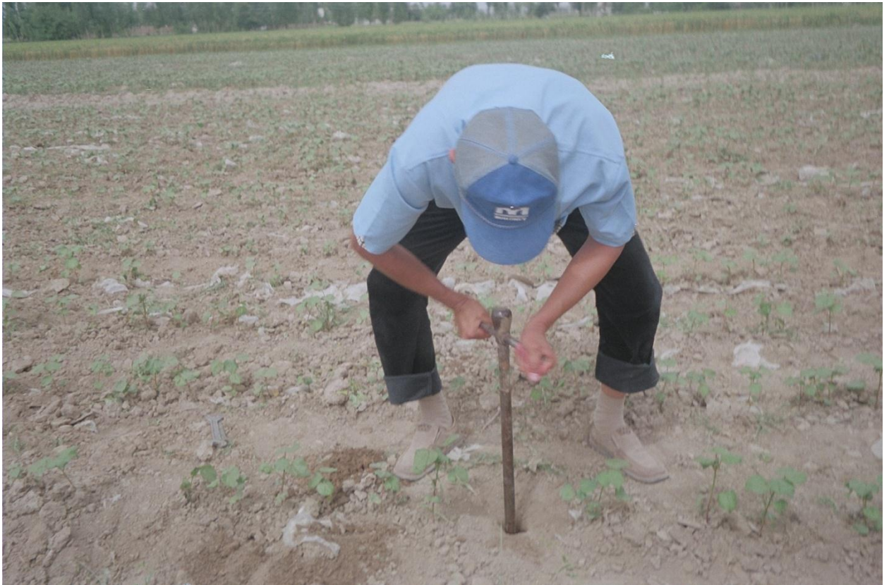
4-rasm Bur yordamida tuproqdagi namlikni o'lchashga tayorgarlik
