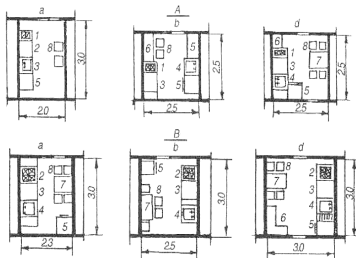
27-расм. Ошхона мебеллари ва жиҳозларини жойлаштиришнинг тахминий лойиҳаси: 4— ошхона; а — бир тарафлама жойлашган жиҳозлар; б — икки тарафлама; д — бурчакли; Б — ошхона емакхонаси билан: а — бир тарафлама; б — икки тарафлама; д - бурчакли; И - икки комфорали ошхона ўчоги; 2 — тўрт комфорали ошхона ўчоги; 3 - иш столи; 4 - идиш ювиш жойи; 5 - совиткич; 6 - осиб қўядиган идиш жавони; 7 — овқат ейиш столи; 8— стуллар.
