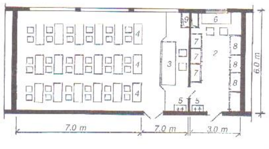
55-расм. Мактаб лабораторияси ва унинг жиҳозлари: 1-лаборатория зали; 2-лаборантлар хонаси; 3-демонстрацион стол; 4-столлар; 5-раковина; 6-ишичи столи; 7-химикатлар қутиси; 8- анжомлар қутиси; 9-ҳаво тортувчи шкаф
