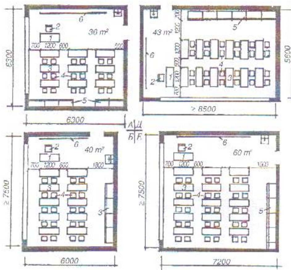
56-расм. Синф хоналарини ташкил этишнинг турли усуллари: А-18 ўқувчи учун; Б-20 ўқувчи учун; Д-24 ўқувчи учун; Е-30 ўқувчи учун; 1-ўқитувчи столи; 2-ўқитувчи стули; 3-ўқувчи столи; 4-ўқувчи стули; 5-секцияли шкаф; 6-доска.
