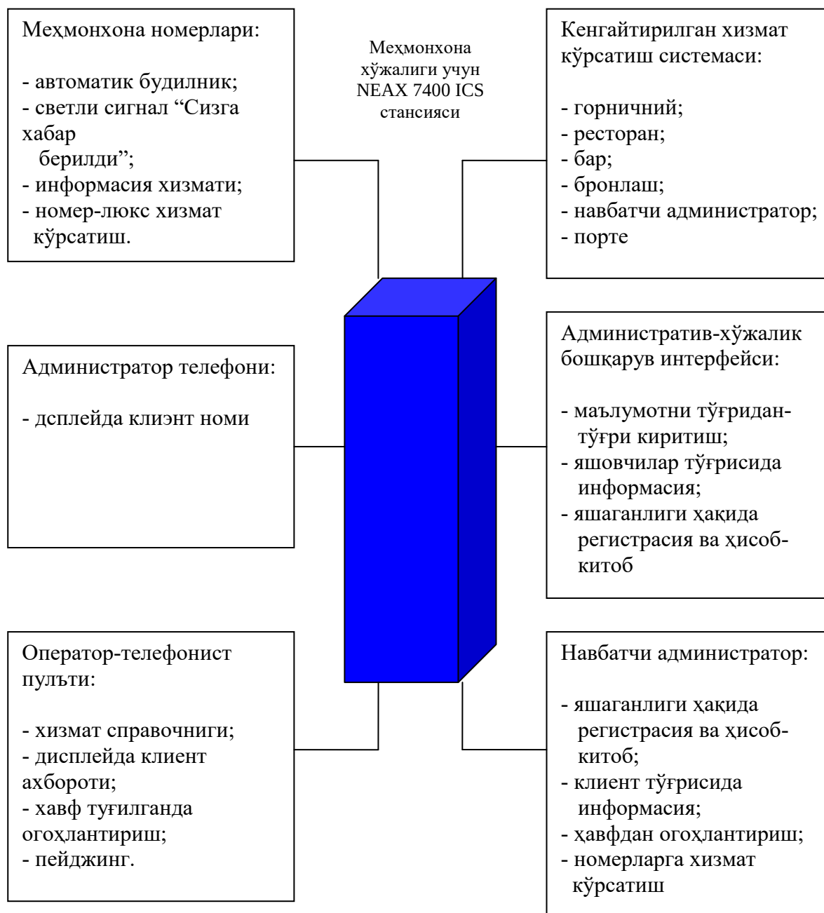
26-расм. Millenium NEAX7400ICS мисолида меҳмонхона учун станция схемаси.
