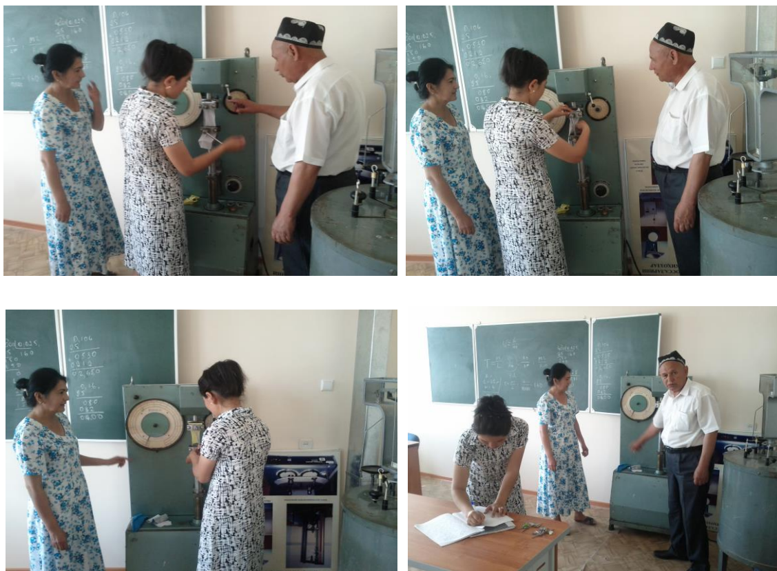
11- расм. RT-250 лаборатория машинасида, газламани чўзилишга пишиқлигини аниқланмоқда.
