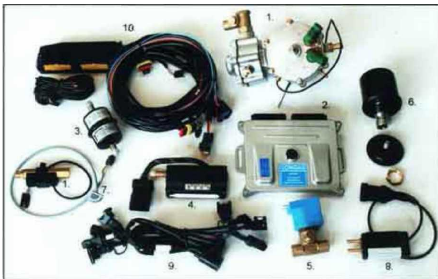
43-rasm. Metan yonilg'isida ishlovchi Longas (4-avlod gaz ballon jihozlari) nomli alohida gaz yetkazish tizimining asosiy jihozlari: 1-reduktor; 2-gaz forsunkalarini elektron boshqarish bloki; 3-gaz filtri; 4-gaz forsunkasi(Matrix); 5-gaz klapani; 6-to'ldirish klapani; 7-ulagich; 8-bosim datchigi.
