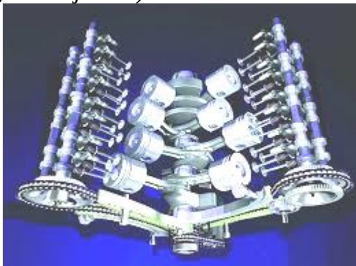
3.6-rasm. To'rt taktili sakkiz silindrli V – simon dvigatel krivoshi-shatunli mexanizmning sxemasi.
