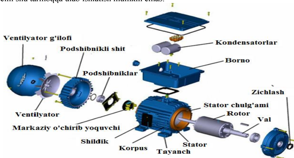
1-rasm. Asinxron dvigatelning umumiy tuzilishi
