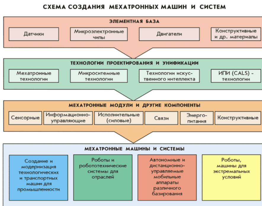
3-расм. Мехатрон харакат модуллари таркибий тузилмаси ва тизими. Мехатрон модуллари ривож.
