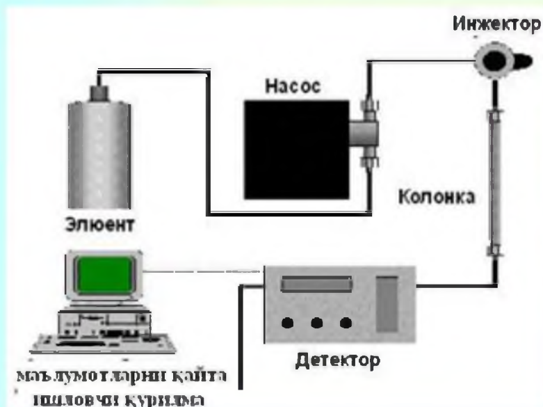
2-расм. Юқори самарали суюқлик хроматографининг тузилиш чизмаси.
