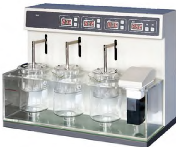
2-rasm. Tabletkalarning parchalanishini aniqlaydigan "identifikator" asbobi a- yig'ma korzinka; b- sig'im (1 l); v- termostat.
