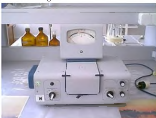
1-rasm. Fotoelektrokolorimetr – KFK-2
