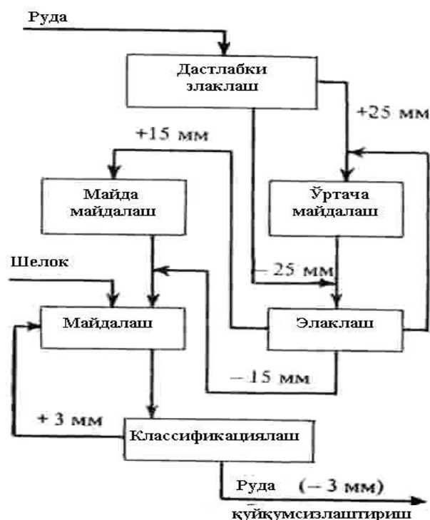
7.1 – rasm. Flotatsiyalashga tayyorlanadigan kaliyli rudani boyitish sxemasi.
