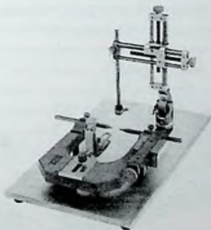
5.5-расм. Тажрибавий ҳайвонлар бошини фиксацияловчи стереотаксик аппарат
