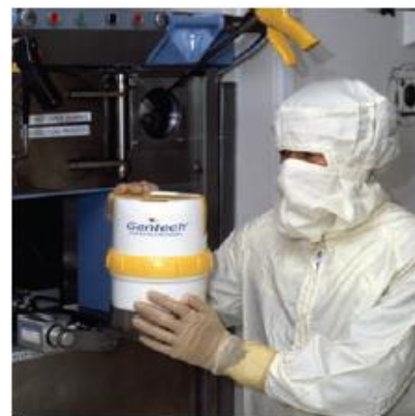
Рисунок 1.3.6.1. Человек, работающий с радиоизотопами должен быть одет в защитную одежду и перчатки, а также защищён экраном.
