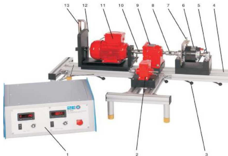
8.1-rasm. AT-200 rusumli reduktorlarni sinash trenajeri.
