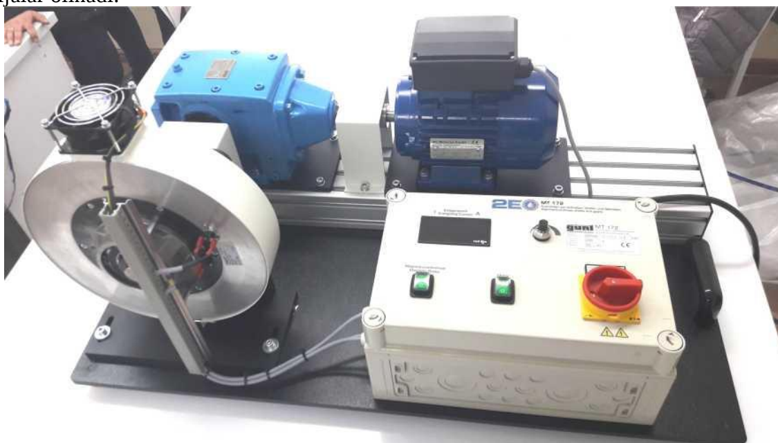
6.1 - rasm. MT-172 rusumli reduktorlarni smash stendining umumiy ko'rinishi.
